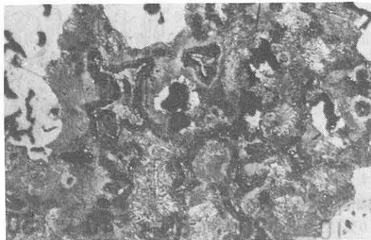
写真2 C: 3.07 wt % Mg 1.0%添加の組織 倍率200倍、腐食液: 5%ピクルル
